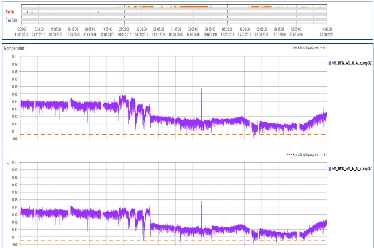
Abbildung 14: Temperaturkompensierte Verformung RFB Arnoldstein – gesamter Messzeitraum
