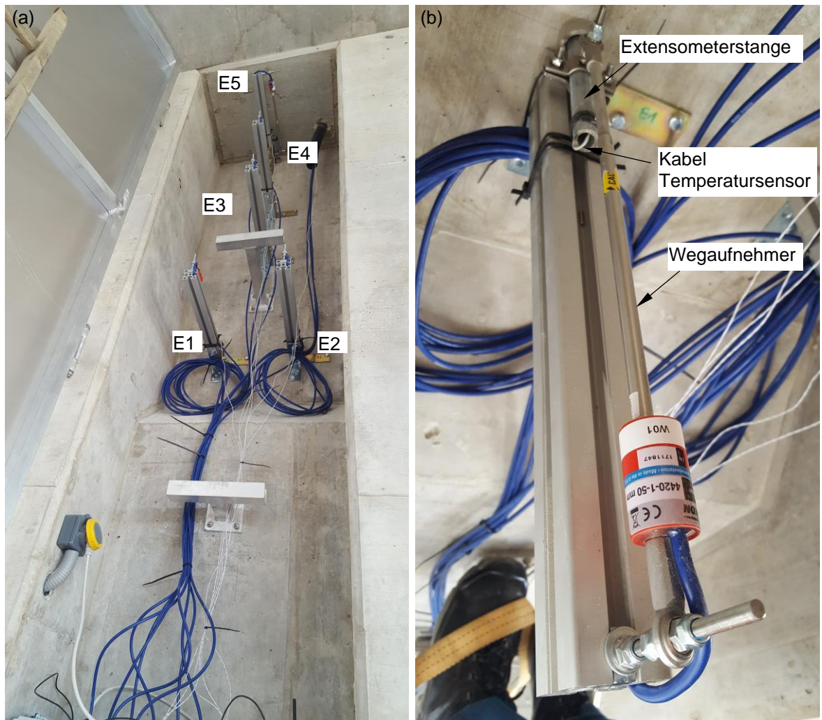
Abbildung 27: Luftseitige Durchführung der Extensometerstangen mit Unterkonstruktion für die Wegaufnehmer (a) Widerlagernische und (b) Sensordetail E1.
