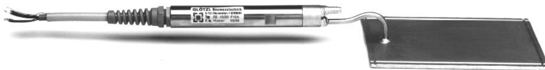
Abbildung 16: Elektrischer Erddruckgeber, Kissengröße 10/20 cm, Ausbildung A
